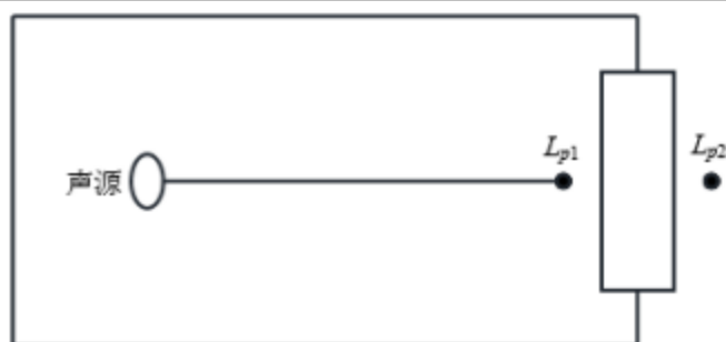
图 4-2 室内声源等效为室外声源图例
